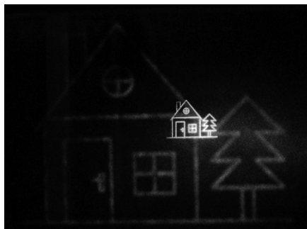
Obr. 1: Rekonstrukce blízkého a vzdáleného hologramu (pro účely fotografování tohoto snímku byly oba obrazy zapnuty současně, při vyšetření jsou rekonstruovány konsekutivně).
